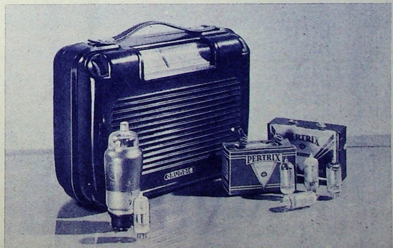
Bild 2. Grundig-Reise-Super 216 B im Größenvergleich zur EBL 1. Rechts sieht man die zugehörigen Batterien und einige Miniaturröhren
